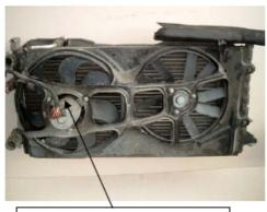
Fig. 1: Electrically driven fan
